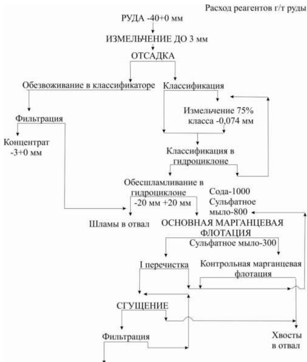
Рисунок 4 – Схема переработки жездинской марганцевой руды на Жездинской обогатительной фабрике
