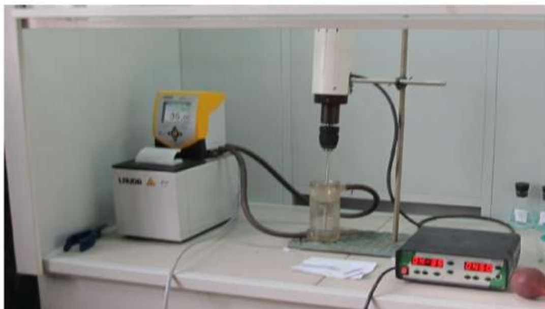
Рисунок 1 - Рабочая установка для исследования выщелачивания на мешалке
