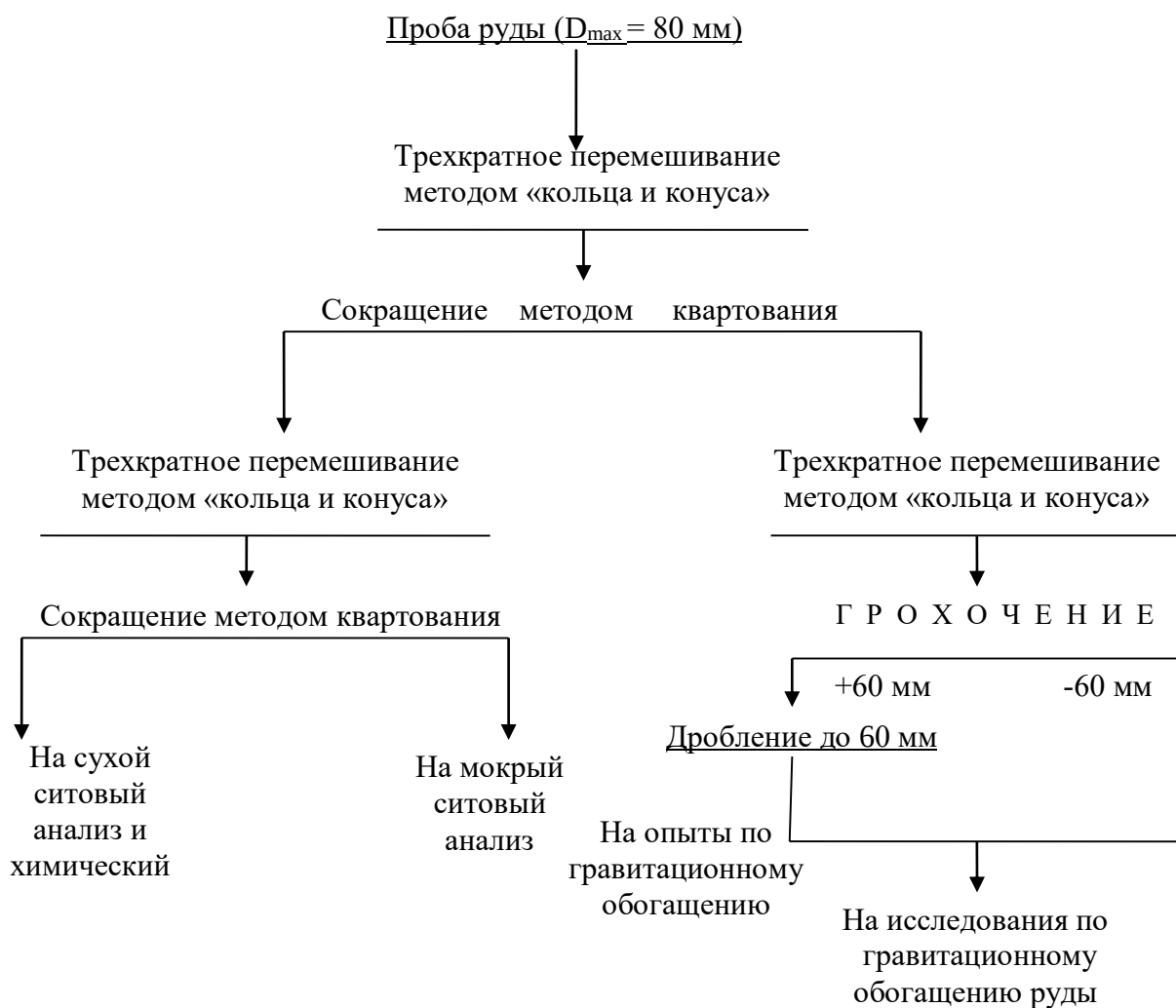
Рисунок 5 –Схема разделки пробы руды
